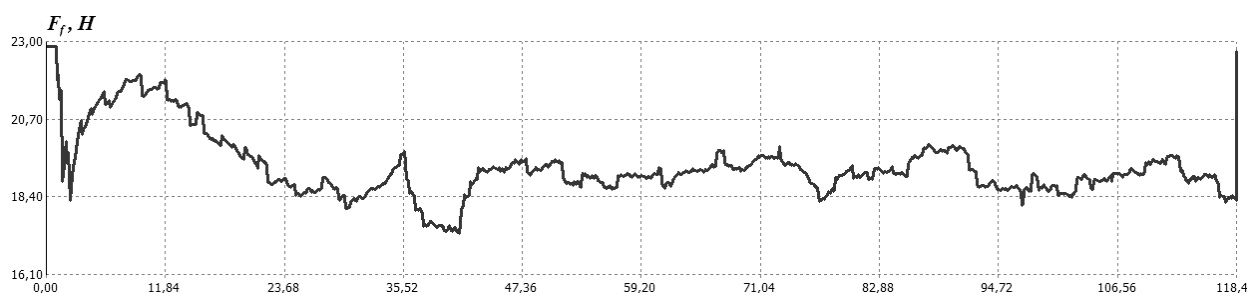
Рис. 8. Зависимость силы трения нижней подборы о дно водоема от времени Fig. 8. Dependence of frictional force leadline about a reservoir bottom from time
